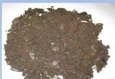
Estos residuos tienen contenidos metálicos que suelen estar entre el 10 y el 30%, principalmente Cu, y en algunos casos Fe, correspondiendo el resto del material a fracciones no metálicas de baja granulometría. Algunas aspiraciones en particular, se consideran desechos peligrosos debido a su contenido de Pb (> 0,3%); siendo de difícil tratamiento, por su fina granulometría y contenido en materia orgánica (20-30%) e inerte (35%).
